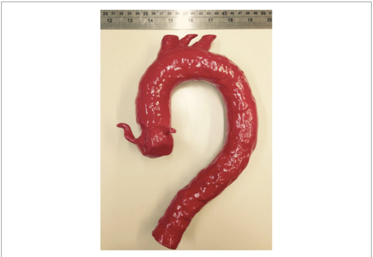
Figura 1 – Modelo aórtico tridimensional. Modelo em material termoplástico ABS-M30 Affordable FDM (Stratasys, EUA).
